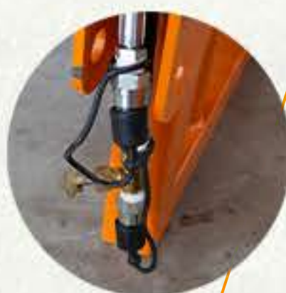
DUAS VÁLVULAS RETENTORAS DE FLUXO DE ÓLEO NOS TÉRMINOS DAS MANGUEIRAS HIDRÁULICAS
